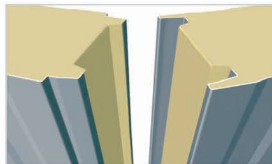
■ Isolation panneaux cellule
